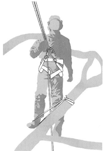
Figure 4 - Exemple d'étrier provisoire au pied créé par une élingue sans fin
