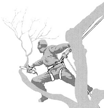
Figure 5 - Exemple d'utilisation de la scie à chaîne à une main
