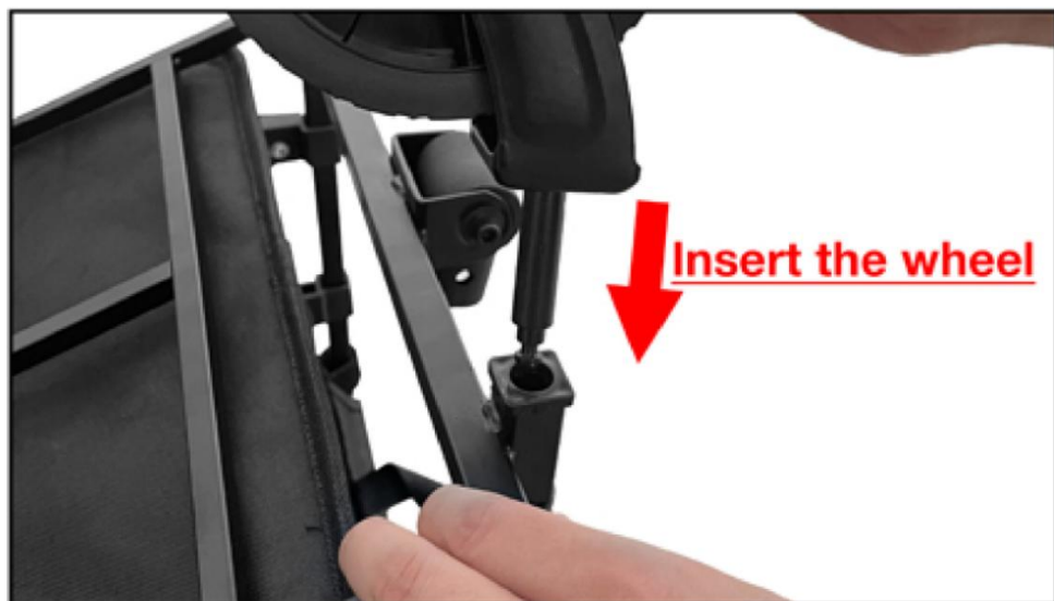
Installation de la roue avant
