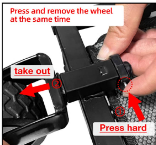
Demontaż przedniego koła.
