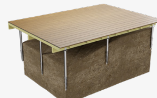
Etape 4 Pose du platelage
