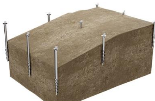
Étape 1 : installation des vis de fondation
