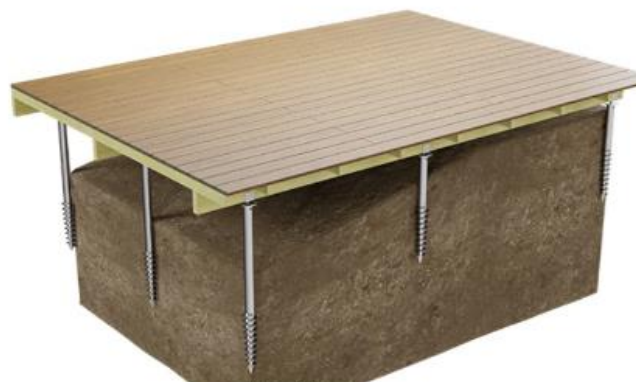
Étape 3 : Pose des lames
